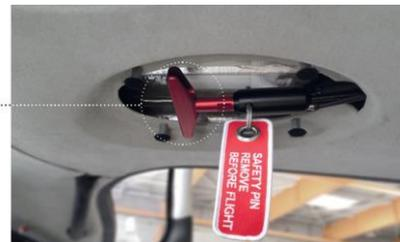
Le pilote doit lors de la préparation de l'avion pour le vol, déverrouiller la sécurité de manière à ce que, lors d'une situation d'urgence, il n'ait plus qu'à tirer la poignée pour déclencher la fusée.
