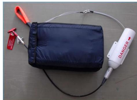
Un BPS se compose d'un parachute empaqueté dans l'avion et d'un dispositif de déclenchement.
